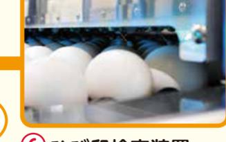
**8 鋭端鈍端汚卵検査装置**
